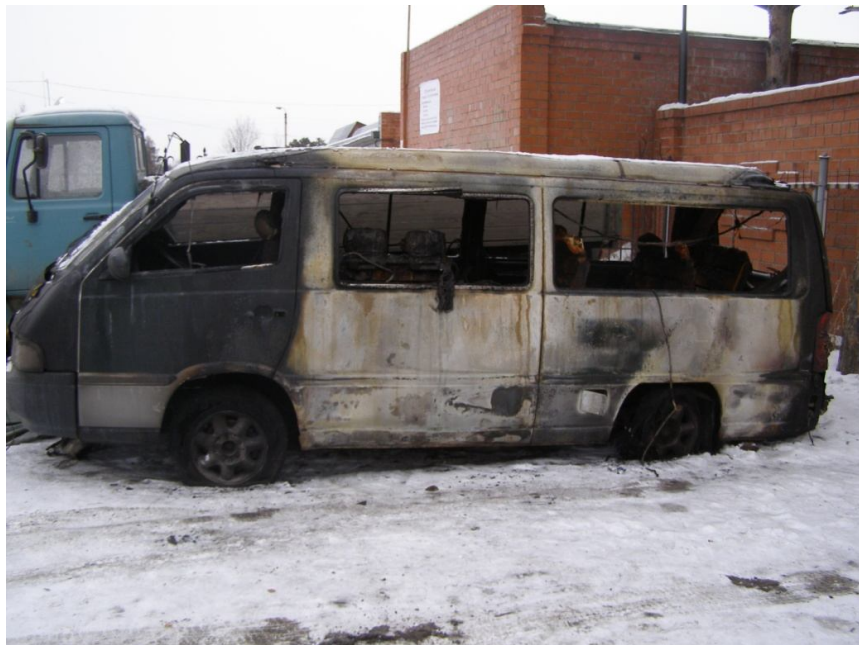
Рис. 2. Термические повреждения левого борта автомобиля SsangYong Istana
