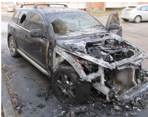
Рис. 1. Разрушение капота и крыльев автомобиля из сплава алюминия
