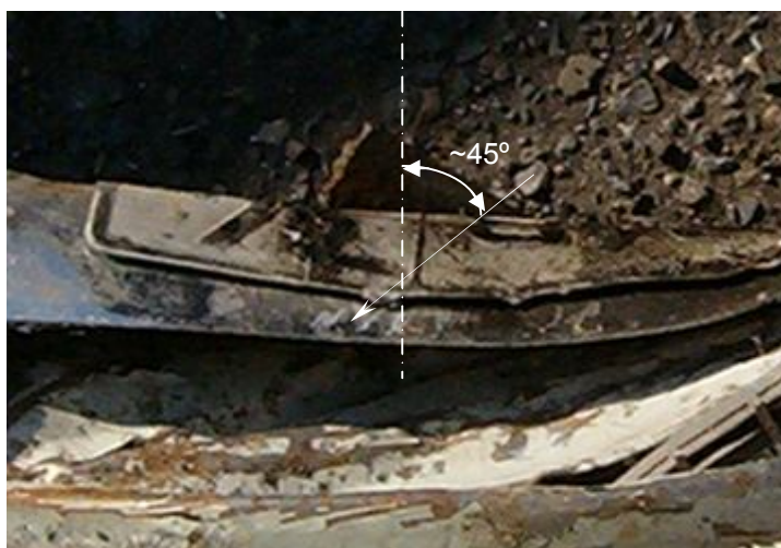
Рис. 5. Следы скольжения на бампере автомобиля ВАЗ-2106
