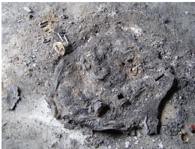
Рис. 3. Фрагмент полимерного топливного бака на полу гаражного бокса
