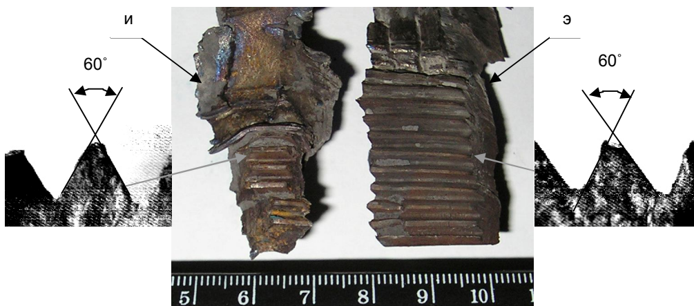
Рис. 4. Соединительная резьба боевой части взрывного устройства
